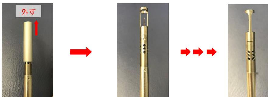
センサーの保護キャップを外し、生徒の胸～顔の高さにかざして測定（ボタン操作は不要）
