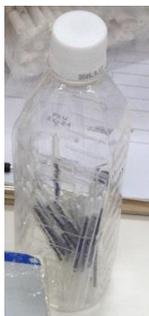
使用後の検知管は空きペットボトルやチャック袋などに入れて持ち帰る。チップカッターの穴からガラス片がこぼれ落ちる事があるので要注意！鋭利なので危ない。また、借りたガス検知器を返却する際は、チップカッターの穴に入っているガラス片をしっかりと取り除いて返却する。
