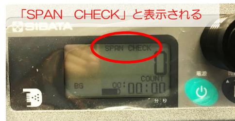
SPAN CHECK と表示されるのを確認 → 開始(1分)
